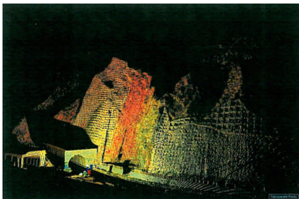
急峻な法面の計測点群データ
